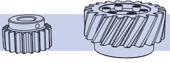
小齿轮采用高级表面硬化钢制成，齿面经过精磨，符合 ISO 1328 的 6 级标准，耐磨性极佳。可提供两种类型的小齿轮，以适应单沿 V 形滑道和平轨道背面的直齿和螺旋齿形制。较小模数的小齿轮的孔带有键槽·安装在驱动轴上。大模数(4 和 5)的小齿轮包含都改成：涨紧套，该套筒拧紧时会锁定在轴上并形成牢固的连接。还可提供标准型的带键槽孔的不锈钢直齿小齿轮。
