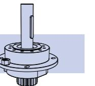
Hepco 驱动法兰组合件可用于所有五种齿条规格<sup>6</sup>。它们设计用于安装在齿条驱动的承载滑座顶部表面上，并连接从齿轮传动电机到小齿轮的驱动装置。配备了高载荷能力滚轮轴承，从而为齿轮传动电机和承载滑座提供坚固的支撑，并可承受高径向载荷<sup>3</sup>。使用螺旋齿条和小齿轮时生成的轴向力，受齿轮箱轴承的支撑。驱动法兰组件配备了独特的微调装置，以实现小齿轮和齿条之间的正确啮合。
