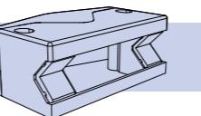
帽型擦刮器可将与滑道啮合的轴承保护起来，并为接触面提供持续润滑，从而极大地增加载荷能力和寿命。它们还可防止碎屑进入并提升安全性和美观性。由装有弹簧并浸满润滑油的毛毡擦刮器进行润滑。小型系列配有注入了润滑脂的中央腔室，这些润滑脂会在运行时变成半溶解状态并润滑擦刮器。
