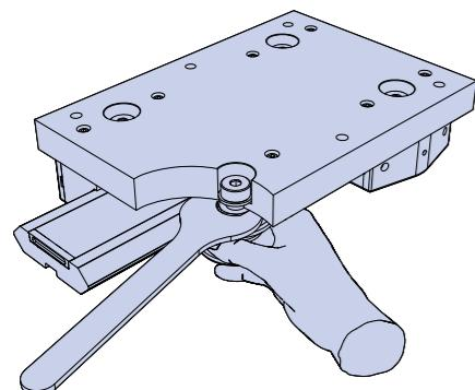
V 形轴承的安装面应平坦且在同一平面内。轴承元件应组装到侧面带有同心轴承的安装面或承载滑座上,以实现最大载荷能力。如果与滑道或轨道的基准(同心)端啮合的轴承组件数量超过两个,则位于两个最外侧同心组件之间的所有轴承都应为偏心类型,从而确保精确啮合和分担载荷。另一面的所有轴承都应该为偏心类型。
