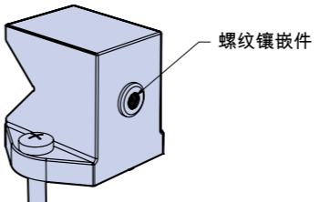
所有类型和规格的润滑装置（详情见 34）均可在润滑点安装螺纹镶嵌件，请参阅相应页面了解具体位置。标配的镶嵌件，可通过在润滑装置部件号上添加如图所示的下标来订购（见 34）。
