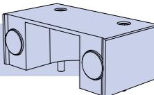
滚轮帽型擦刮器可将安装在平轨道上的轨道滚轮保护起来，并为接触面提供持续润滑，从而延长系统寿命。它们还可防止碎屑进入并提升安全性和美观性。润滑剂通过装有弹簧并浸满润滑剂的毛毡擦刮器涂抹到轨道表面。滚轮帽型擦刮器采用抗冲击塑料制成，并可轻松从系统中拆下以调整轨道滚轮。提供了两种连接方式，从上方或从下方。
