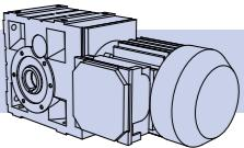
Hepco 齿条驱动承载滑座可随 AC 齿轮传动电机一并提供，从而提供一种简单且低成本的实现点到点线性运动的方式。标准配备中提供了带中空输出轴的螺旋齿锥齿轮箱。紧凑型设计可增强 Hepco 齿条驱动承载滑座和中空轴的刚性，从而允许以最大刚性直接连接驱动法兰组合件。
