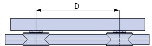
$$\text{载荷系数 } L_F = \frac{L_1}{L_1(\text{最大})} + \frac{L_2}{L_2(\text{最大})} + \frac{M_s}{M_s(\text{最大})} + \frac{M_v}{M_v(\text{最大})} + \frac{M}{M(\text{最大})}$$
