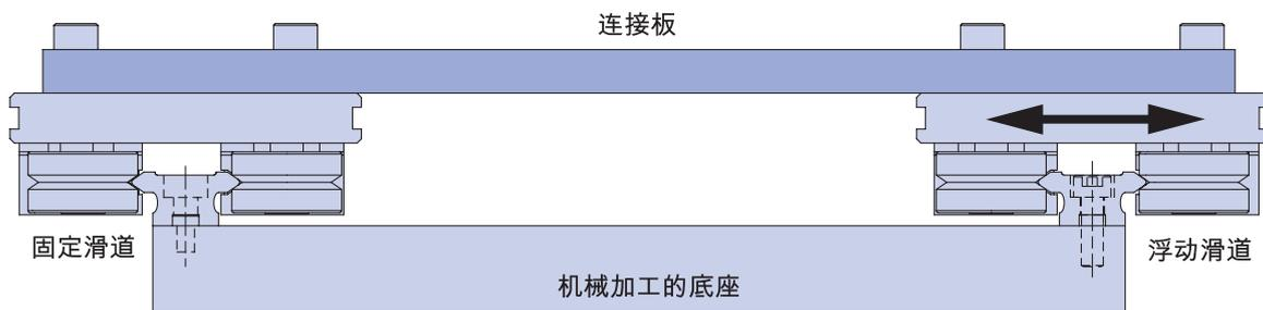
图 3.2 使用定位销时的滑道设置程序。
